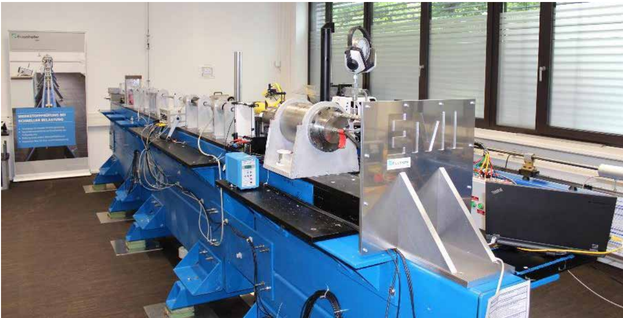
The Hopkinson bar at Fraunhofer EMI.
